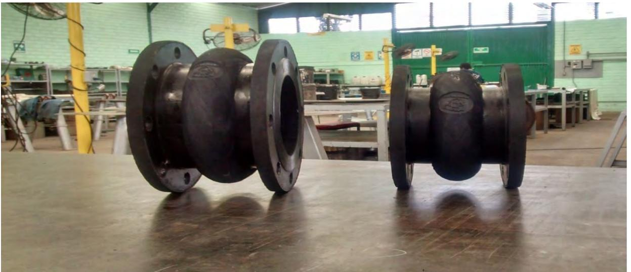
Las juntas de expansión son dispositivos flexibles diseñados para absorber los movimientos generados en los sistemas de tuberías por variaciones de temperatura y presión. Al absorber los movimientos reducen la vibración mecánica ocasionada por otros equipos y disminuye el ruido de la tubería.
