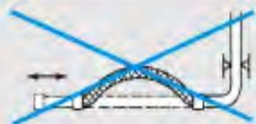
No permitir movimientos axiales, sino prever la instalación verticalmente al eje de la manguera.
