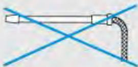
No doblar en exceso en el extremo, sino instalar en un desvío rígido.
